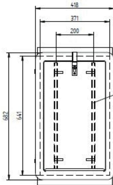
C-Profil Gleisschiene mit Schiebemuttern
